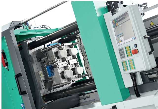
Bild 1. Typisch für schnelllaufende Anwendungen mit kurzen Einspritzzeiten sind Dünnwandartikel wie Rundbecher, hier mit einem 4-fach-Testwerkzeug
